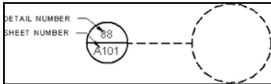
Figure 7.3.p.: Section Cut
